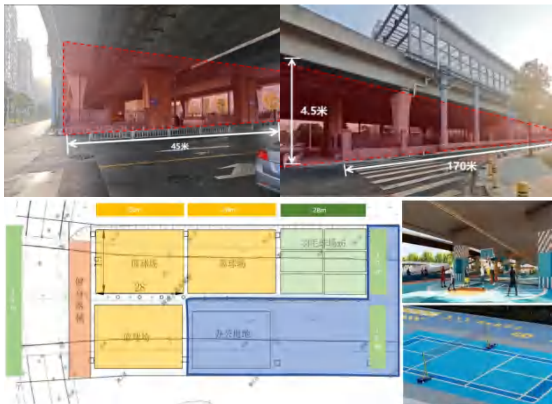
图 30—2 净高分级与竖向复合利用技术示意图
